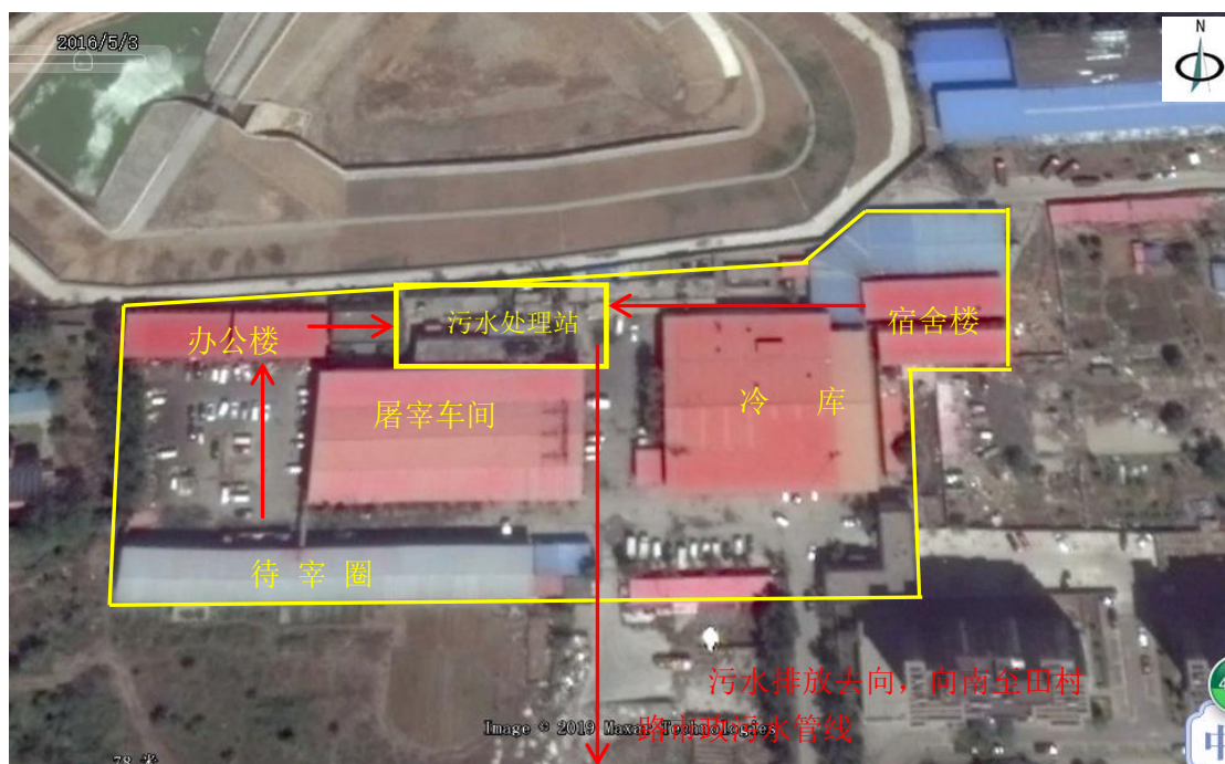
图 3-6 西黄村牧业食品公司污水走向图
